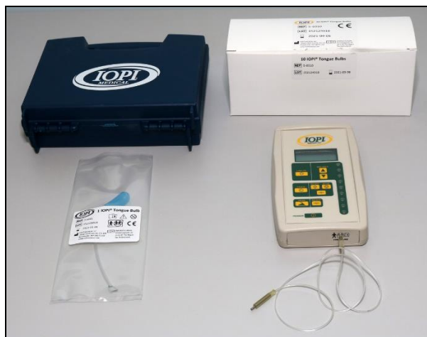
Figura 5. Transdutor com tela de LCD, tubo plástico e bulbo plástico.
