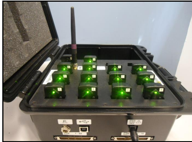
Figura 3. Eletromiógrafo Delsys Trigno TM wireless.
