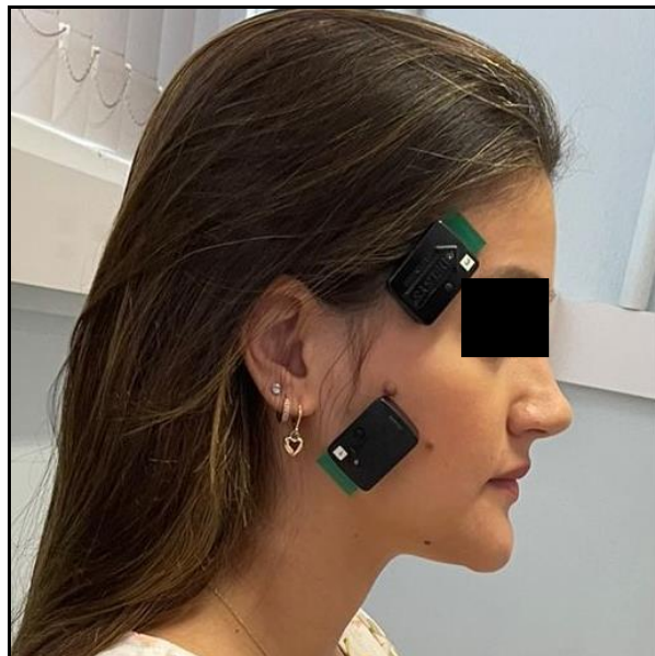
Figura 4. Posicionamento dos sensores nos músculos masseter e temporal.
