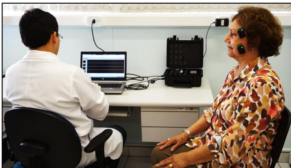
Figura 2 - Eletromiógrafo Trigno™ Wireless Emg System Delsys® com eletrodos ativos.
