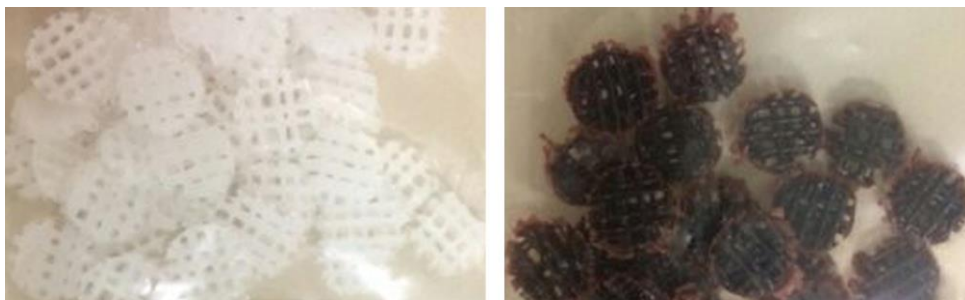
Figura 3. Scaffolds de PLLA e scaffolds de PLLA/licopeno construídos em impressora 3D para serem implantados na calvária.
