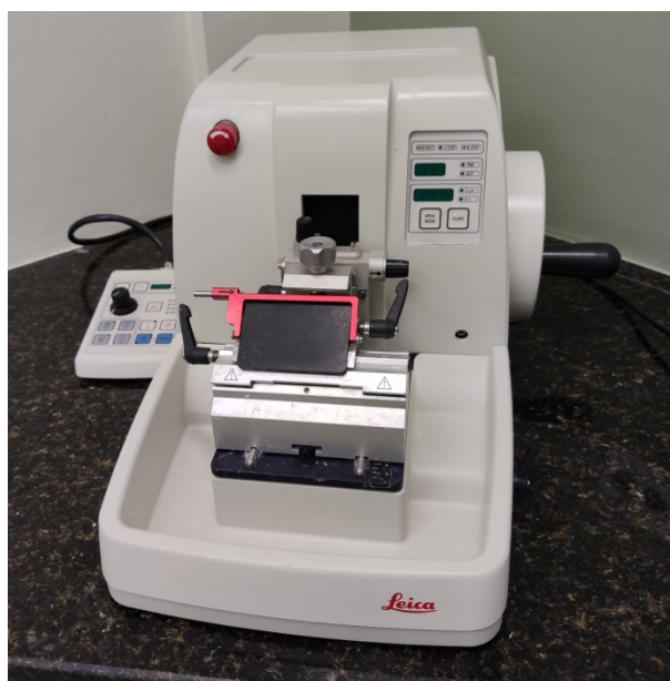
Figura 8. Micrótomo rotativo Leica RM2255® (Leica, Wetzlar, Alemanha) do Laboratório de Histotecnologia da FORP-USP utilizado para confecção dos cortes histológicos.
