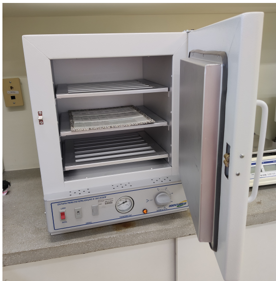
Figura 9. Após a montagem, as lâminas foram mantidas a 50°C em estufa (Biodont, Brodowski, Brasil), para fixação do corte histológico e remoção do excesso de parafina.
