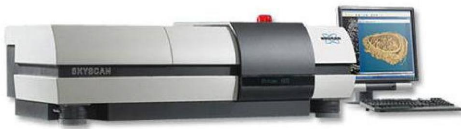
Figura 2. O microtomógrafo SkyScan® 1172 (Bruker, Kontich, Bélgica) do Laboratório Multiusuário para Análises de Imagens Tridimensionais de Tecidos Biológicos e Biomateriais (LAB 3D BIO) da FORP- USP foi utilizado para escaneamento das peças. (Fonte: www.bruker.com/pt/products/microtomography ).
