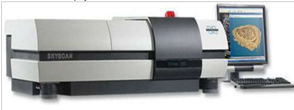
Figura 4. O microtomógrafo SkyScan® 1172 (Bruker, Kontich, Bélgica) do Laboratório Multiusuário para Análises de Imagens Tridimensionais de Tecidos Biológicos e Biomateriais (LAB 3D BIO) da FORP- USP foi utilizado para escaneamento das peças.
