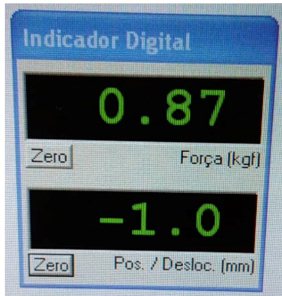
Figura 16: Indicador digital do aparelho EMIC, com valores da força aplicada (kgf) e do deslocamento (mm).
