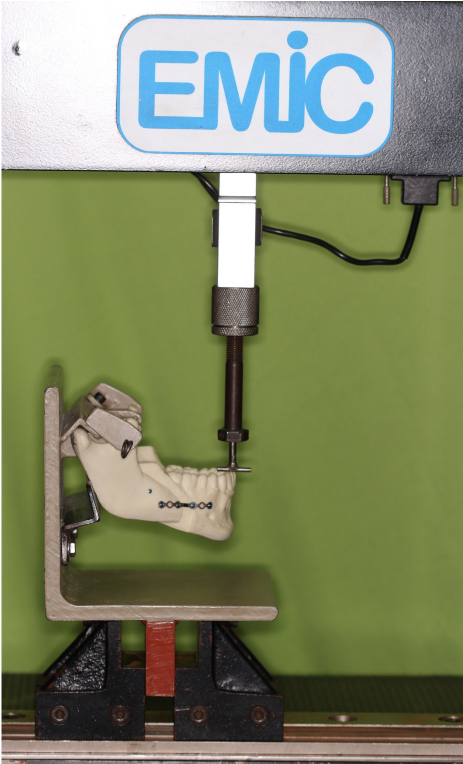
Figura 13: Máquina universal de ensaios, da marca comercial EMIC, modelo DL2000 e dispositivo de aço para aplicação de carga e de suporte para mandíbula de poliuretano. Mandíbula posicionada no início do teste.
