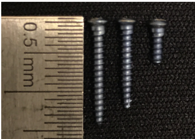
Figura 8: Parafusos 16, 14 e 6 mm, respectivamente, utilizados para fixação.
