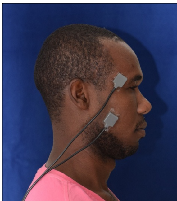
Figura 21 - Posição dos eletrodos para captar os sinais EMG
