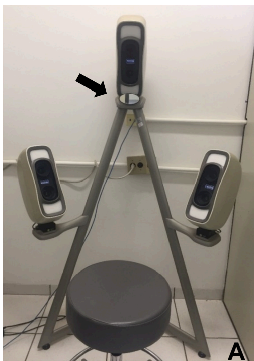
Figura 2 - A- Sistema de estereofotogrametria Vectra M3 com seus módulos corretamente posicionados e o mocho onde o paciente é posicionado, sempre olhando fixamente para o espelho central (seta); B- Monitor Dell em tela plana onde foram feitas as análises.
