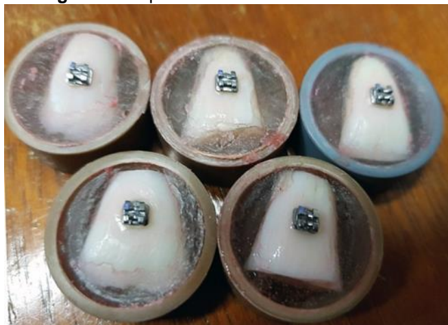
Figura 6 - Espécimes com acessórios colados
