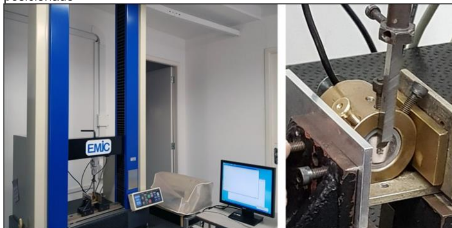
Figura 7 - Máquina de Ensaio Universal - Cinzel utilizado - Espécime posicionado
