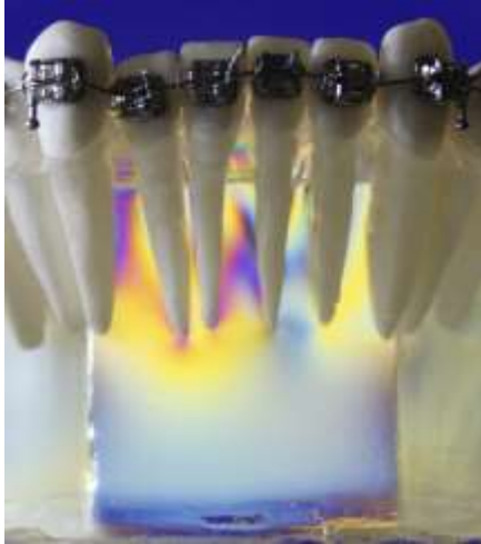
Figura 8: Bráquete metálico, ligadura metálica e fio Niti .014".
