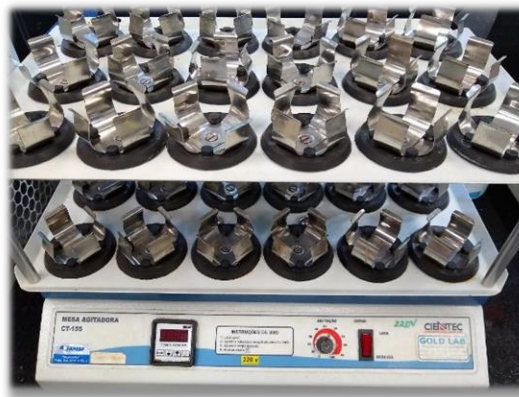
Figura 3. Mesa agitadora usada nos desafios erosivos.
