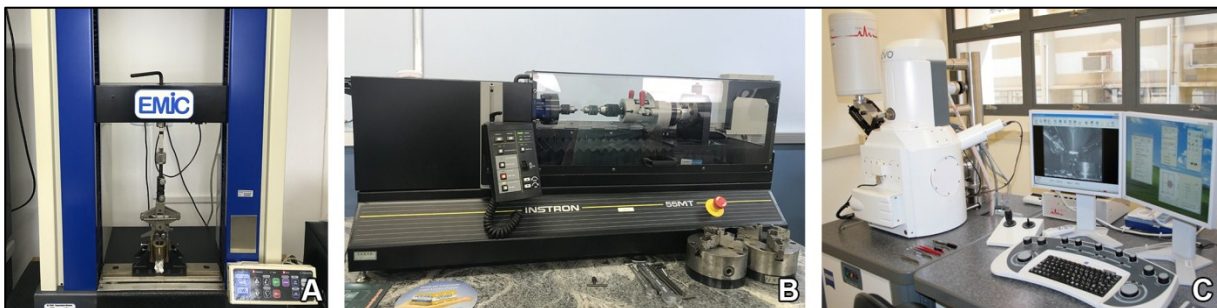
Figura 2. A. Máquina universal EMIC para teste de atrito e flexão. B. Máquina Instron 55MT para o ensaio de torção. C. Microscópio eletrônico de varredura e Espectrômetro de raios-X pós dispersão de energia.
