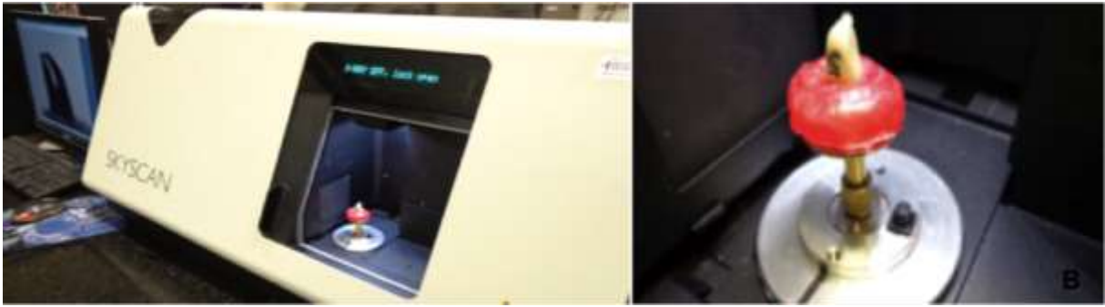
Figura 1. (A) Microtomógrafo SkyScan modelo 1174 (SkyScan, Kontich, Bélgica). (B) Posicionamento do espécime no interior da câmara do microtomógrafo.
