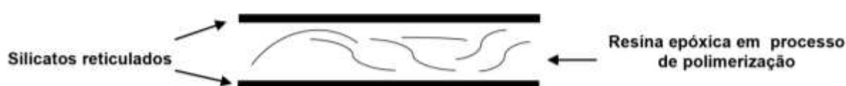
Figura 22. Esquema ilustrativo do processo de polimerização de cimentos resinosos na presença de materiais à base de silicatos e óxidos de cálcio.
