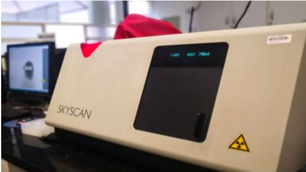
Figura 2. Microtomógrafo SkyScan modelo 1174 (SkyScan, Kontich, Bélgica) utilizado no escaneamento preliminar para seleção das amostras.
