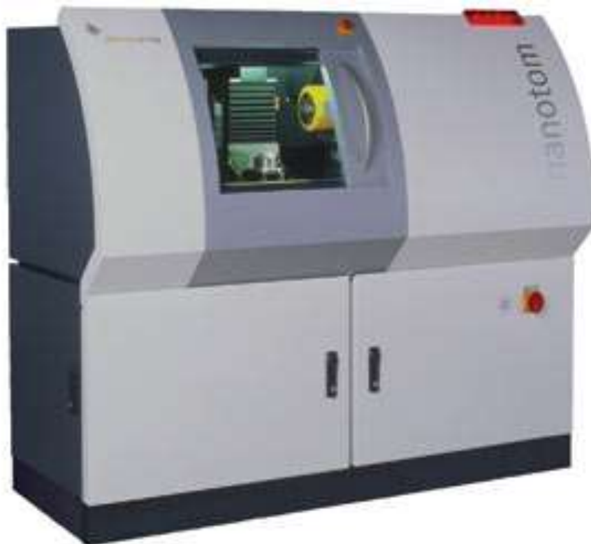
Figura 3. Nanotomógrafo computadorizado Phoenix NanoTom M (GE, Wunstorf, Alemanha) alocado no Departamento de Física, Química e Engenharia - Faculdade de Ciências da Engenharia da Universidade Católica de Leuven, Bélgica.
