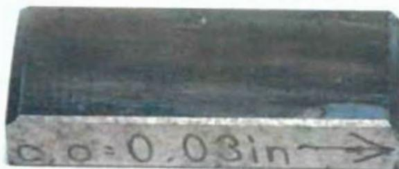
**Figura 20 – Amostra metálica padrão fornecida pelo fabricante para calibrar o aparelho rugosímetro Prazis Rug-03.**
