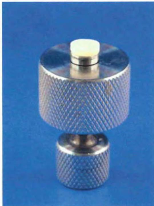
**Figura 11 – Matriz metálica circular de aço inoxidável – fotografia lateral com o corpo-de-prova sendo expelido.**
