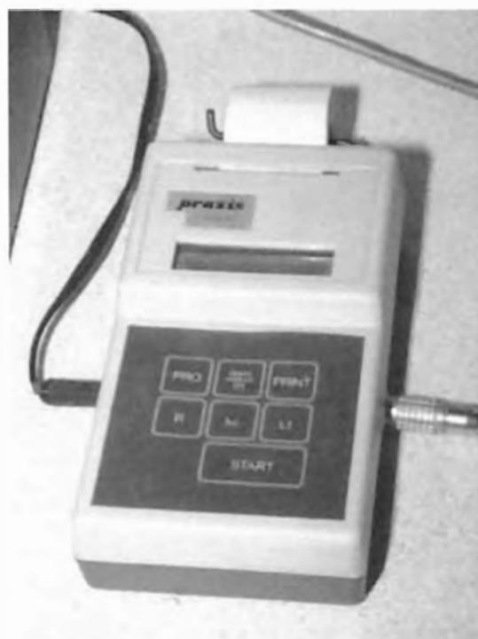
**Figura 17 – Unidade programadora e registro de leitura do aparelho rugosímetro – Prazis Rug-03.**
