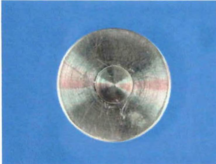
**Figura 10 – Matriz metálica circular de aço inoxidável - fotografia superior.**
