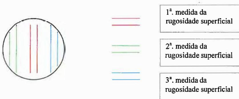
Esquema da seqüência da medição no disco de resina composta.
