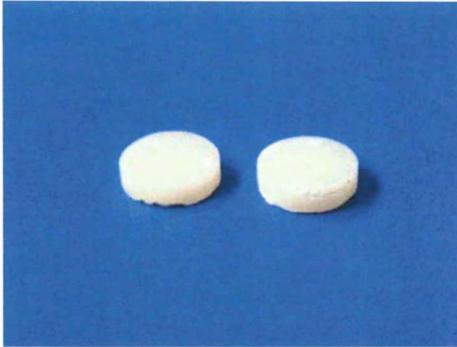
**Figura 8 – Corpos-de-prova, iguais para todas as resinas compostas compactáveis.**
