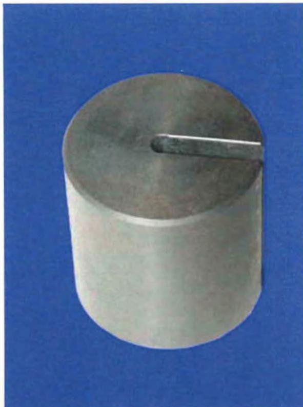
**Figura 19 – Mesa móvel onde é fixado o corpo-de-prova para a leitura da rugosidade superficial.**
