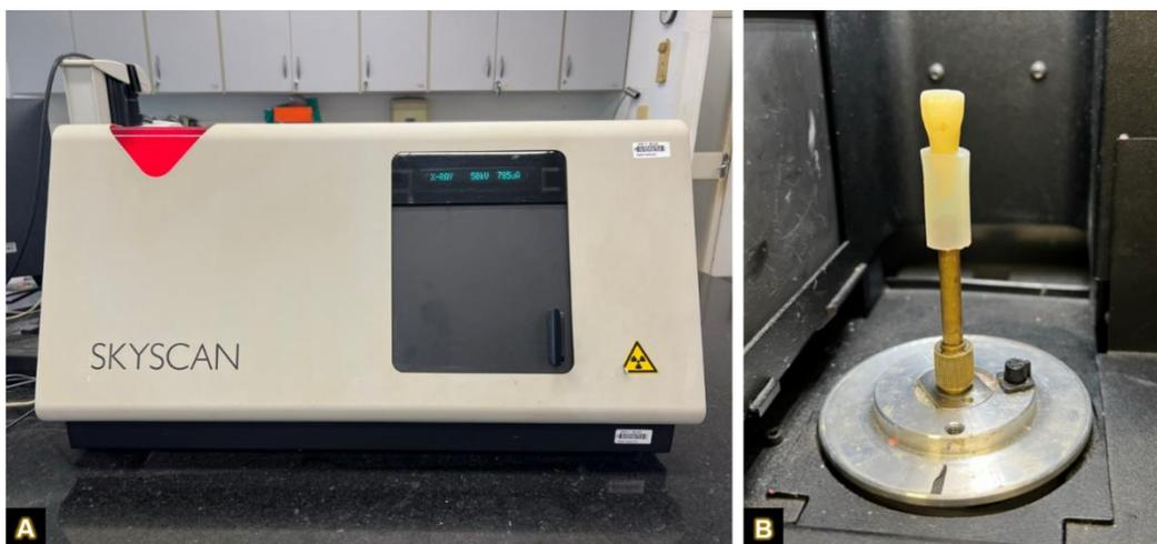
**Figura 2.** Escaneamento pré-operatório: (A) Microtomógrafo SkyScan 1174; (B) Posicionamento do dente no suporte no interior da câmara do microtomógrafo.
