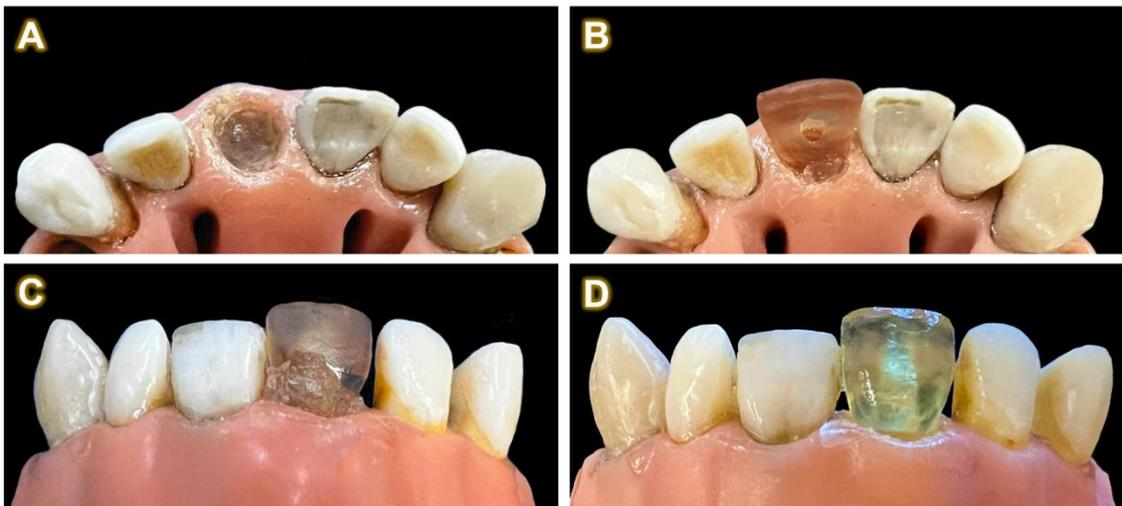
**Figura 16.** Posicionamento do dente impresso no manequim: (A) Gel de agarose no alvéolo (B) Vista oclusal do dente impresso no alvéolo evidenciando excesso de agarose; (C) Visão frontal do dente evidenciando excesso de agarose; (D) Dente reposicionado no alvéolo correspondente.
