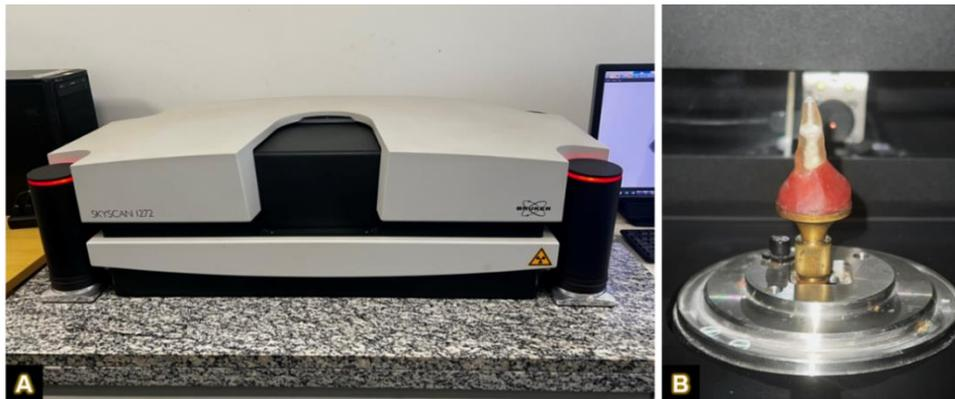
**Figura 25.** Escaneamento pós-operatório: (A) Microtomógrafo SkyScan 1272; (B) Dente de resina obturado posicionado na porta amostra.
