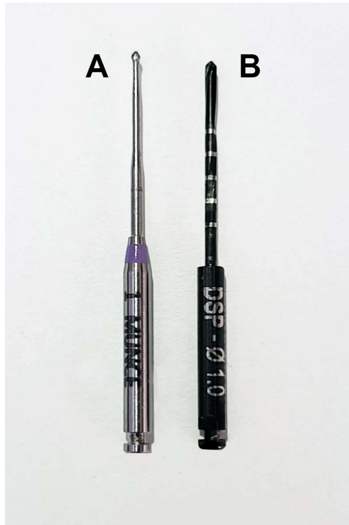
Figura 2 – A Size 1 Munce Discovery bur (CJM Engineering, Santa Barbara, EUA), fresa esférica, com cabeça com 0,8 mm de diâmetro e pescoço com diâmetro variável entre 0,7 e 1 mm, com comprimento total de 34 mm. B- DSP 1.0 mm, helicoidal, com 1 mm de diâmetro e comprimento total de 25 mm.
