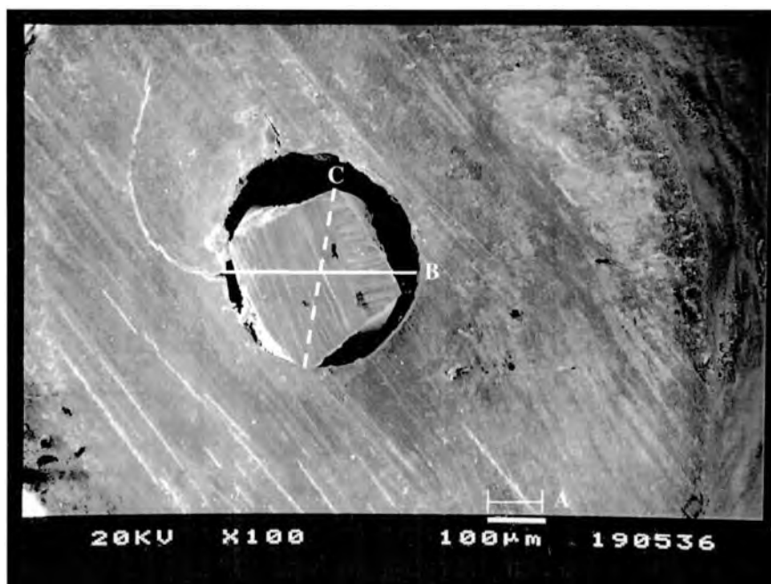
Figura 7. Mensurações realizadas em cada fotomicrografia eletrônica de varredura: A- medida da escala da fotomicrografia; B- menor diâmetro do canal; C- diâmetro do instrumento.
