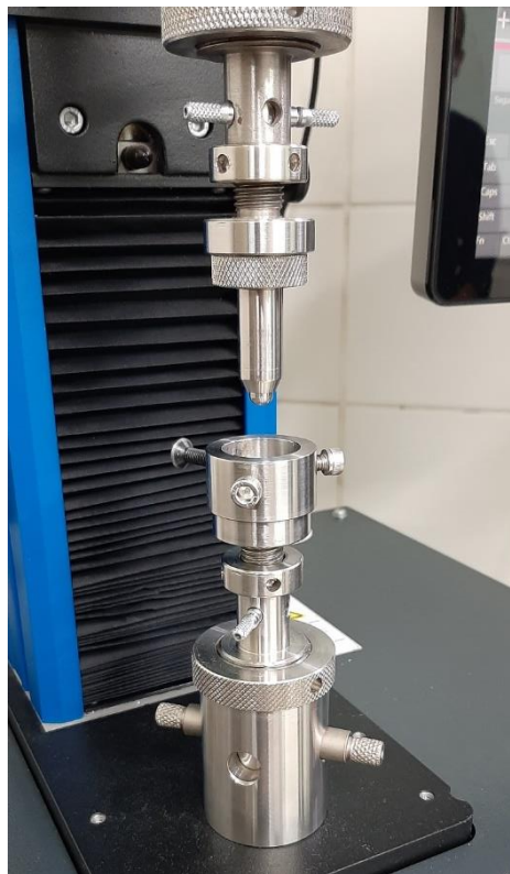
Figura 6. Suporte e ponta esférica (8mm) utilizados para realização do teste de resistência a fratura
