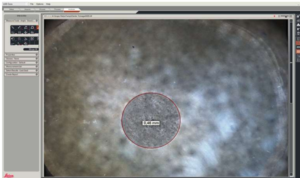
Figura 9. Tela do software mostrando a delimitação do material restaurador intracanal para a mensuração do raio no estereomicroscópio Leica M165C, por meio da demarcação de 3 pontos na interface adesiva com a ferramenta Circle Tool (Three Point Type) .
