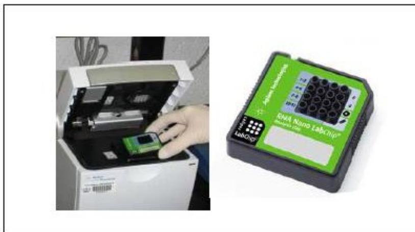
**Figura 5.** Aparelho Bioanalyzer 2100 Agilent e RNA 6000 Nano Chip utilizados na eletroforese microfluídica.
