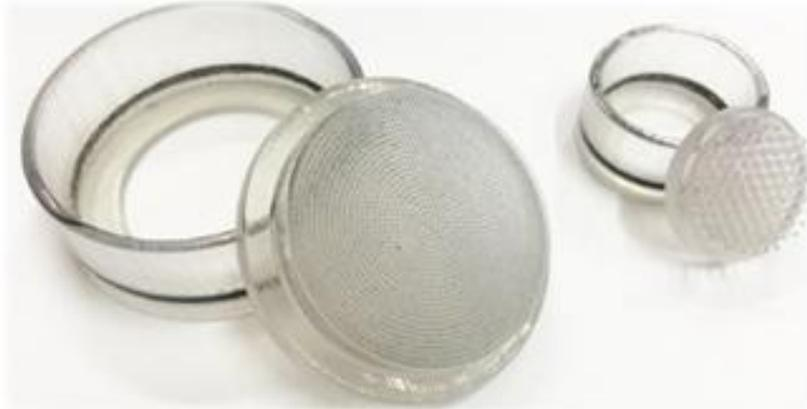
**Figura 5.** Moldes de acrílico com pinos de 600  $\mu\text{m}$  confeccionados por Impressão 3D.
