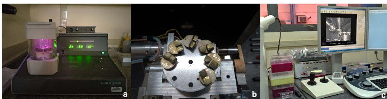
Figura 6. a. Espécimes em processo de recobrimento com ouro-paladium; b. Espécimes fixados em stubs e para análise em microscópio eletrônico de varredura; c. Espécimes sendo visualizados e imagens sendo realizadas.
