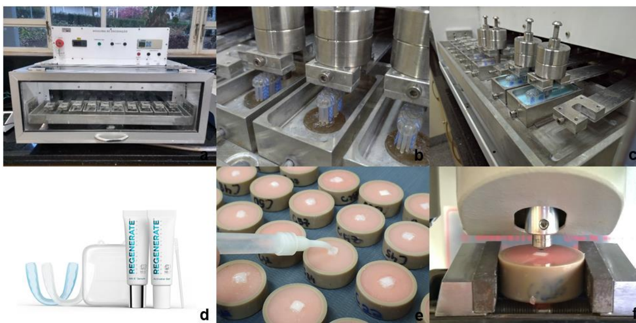
Figura 5. a. Máquina de esovação utilizada no presente estudo; b. espécimes posicionados na máquina de escovação; c. espécimes posicionados com a adição do slurry ; d. Regenerate™ Boosting Serum Gel; e. Aplicação de tratamento de superfície pós-clareamento; f. espécime posicionado em máquina de ensaio para o teste de microdureza Knoop (KNH).
