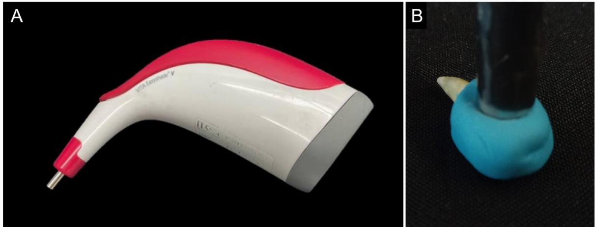
Figura 1. (A) Espectrofotômetro Easyshade V (Vita Zahnfabrik H. Rauter GmbH & Co. KG, Bad Säckingen, Alemanha) utilizado para avaliação quantitativa da cor. (B) Posicionamento da ponta do espectrofotômetro na área de exposição de esmalte para leitura da cor.
