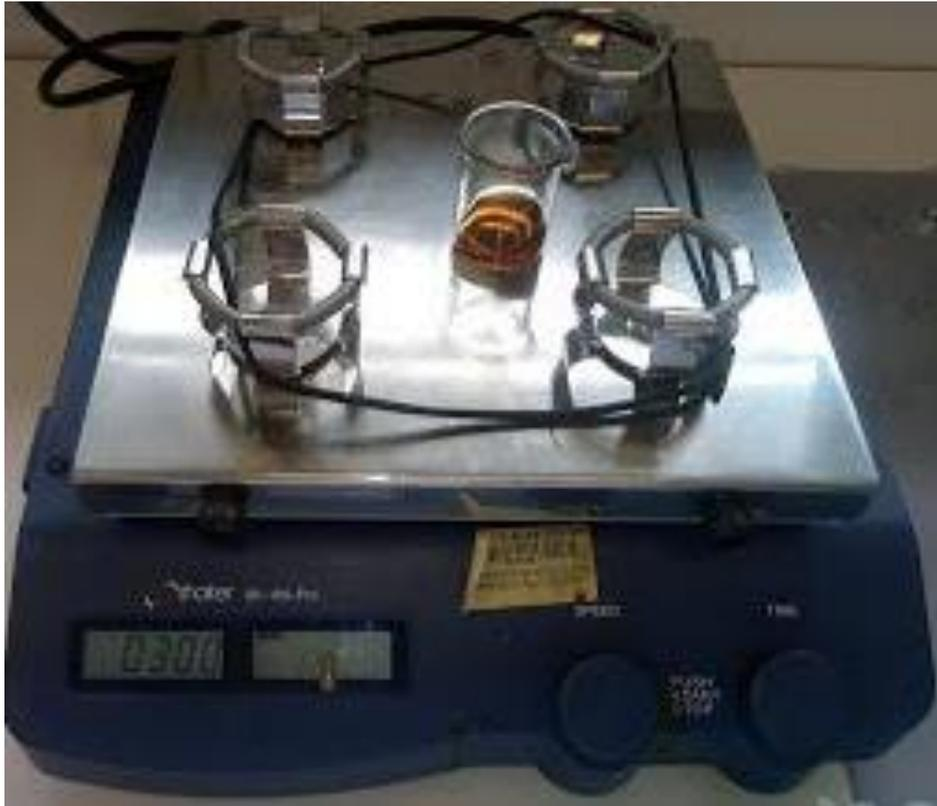
**Figura 7-** espécime em solução ácida submetida a agitação leve (300rpm).
