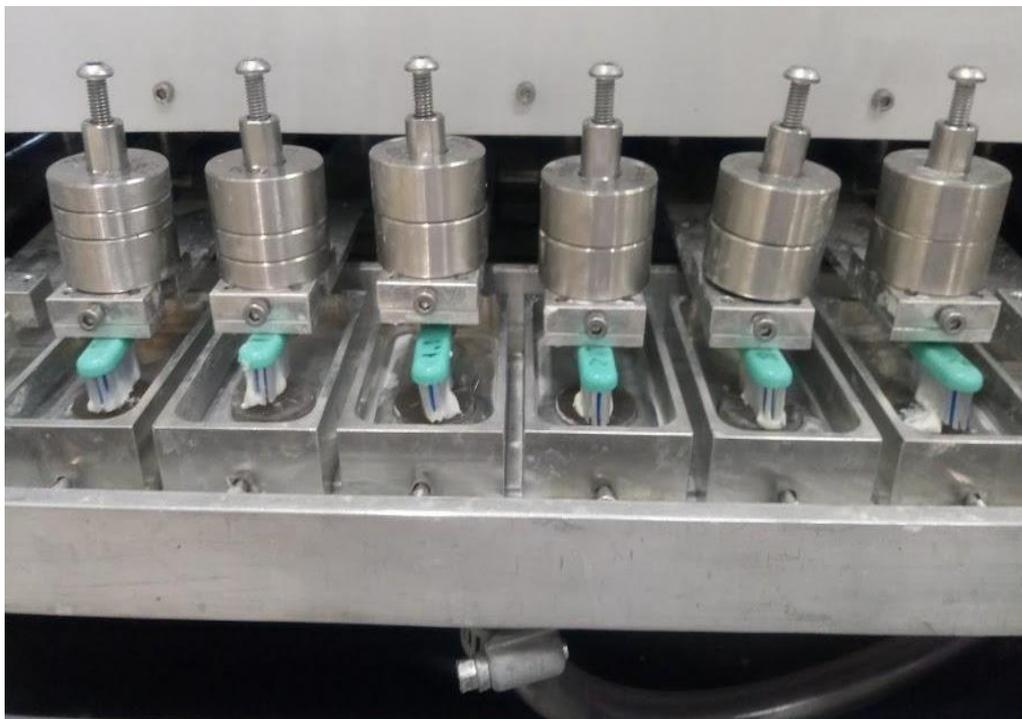
**Figura 6** - Espécimes posicionados na máquina de escovação com carga de 200g.
