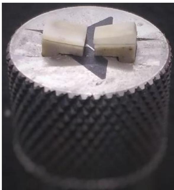
**Figura 5** - Espécimes cortados e adaptados ao aparato do equipamento de análise de carga superficial.
