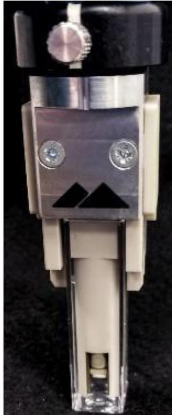
**Figura 8** - espécime fixado em suporte e inserido em cuba contendo dispersão de nanopartículas de poliestireno.
