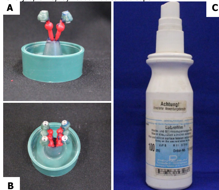
Figura 9: A e B - Posicionamento das peças para posterior fundição; C - Spray redutor de tensão superficial.
