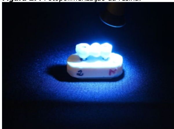
Figura 27: Fotopolimerização da resina.
