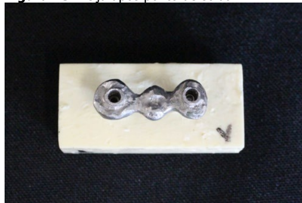
Figura 15: Peça após ponto de solda.
