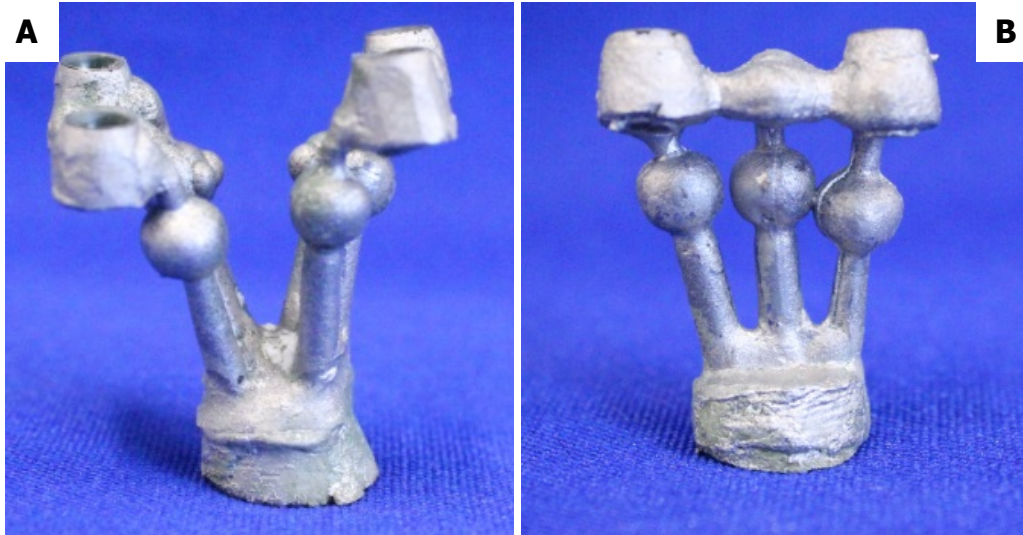
Figura 12: A e B - corpos de prova após jateamento com partículas de óxido de alumínio.
