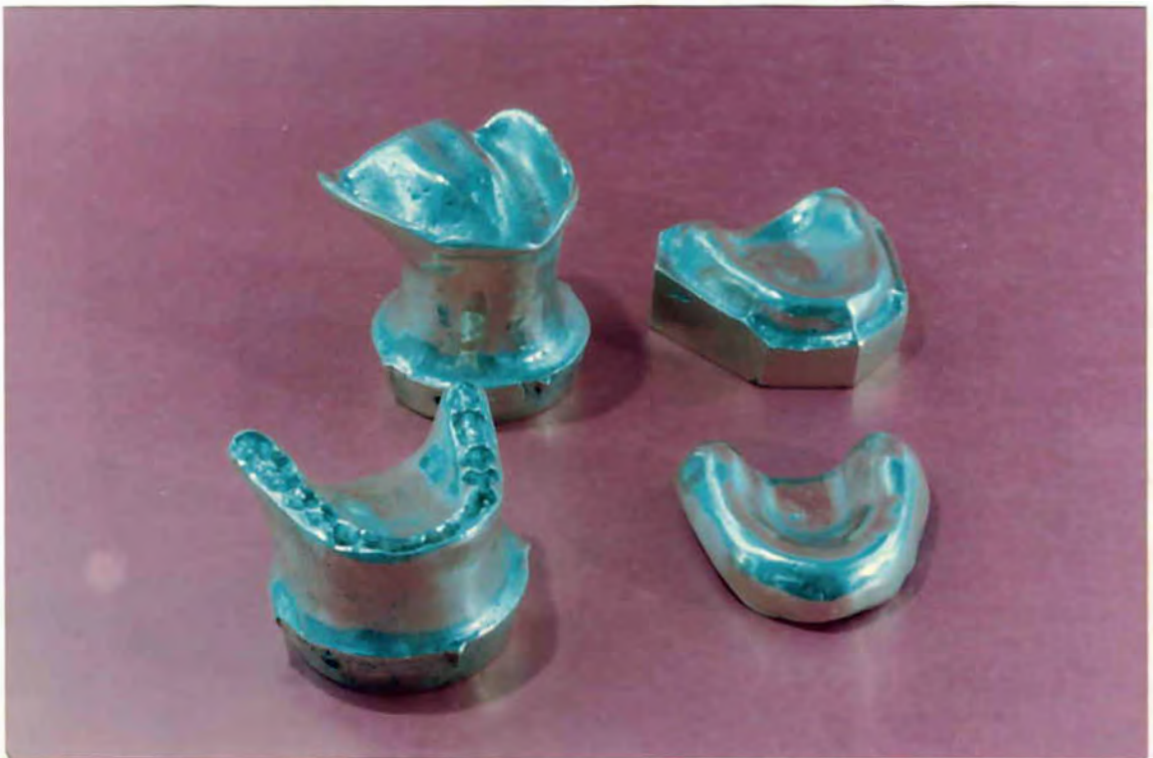
Figura 2 - Modelo Mestre, Base de Prótese, Padrão 1 e Padrão 2, fundidos em liga de Cobre e Alumínio
