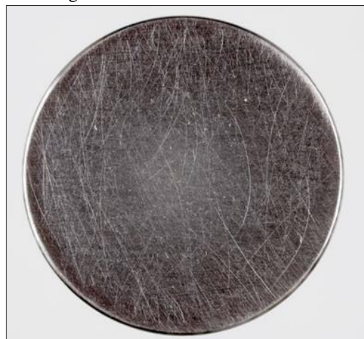
Figura 1. Disco Ti-6Al-4V obtido pelo processo de usinagem.
