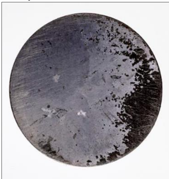
Figura 5. Disco Ti-6Al-4V obtido pelo processo de usinagem após tratamento de superfície de hidroxiapatita.
