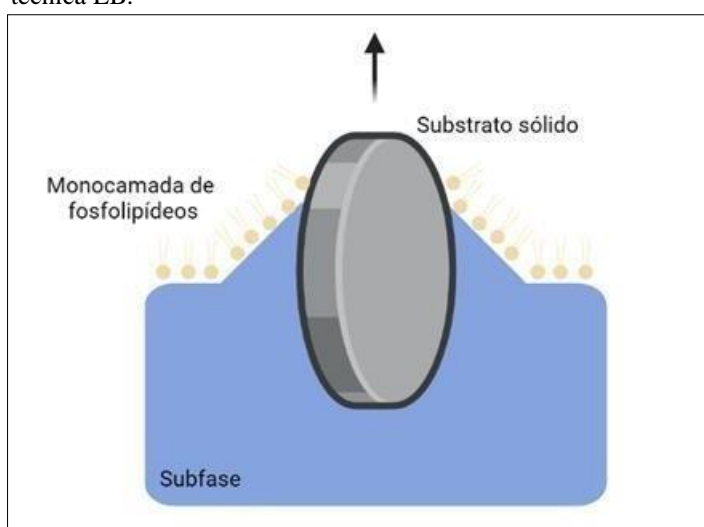
Figura 2. Esquema ilustrativo da formação de monocamadas pela técnica LB.
