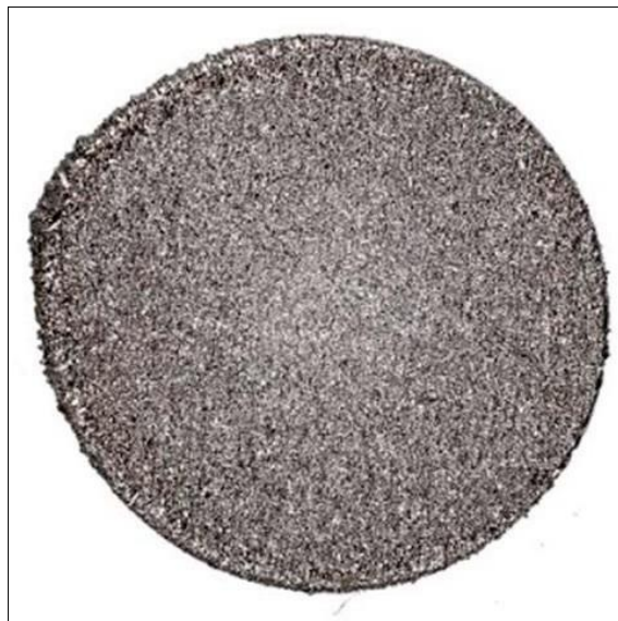
Figura 8. Disco Ti-6Al-4V obtido pelo processo de manufatura aditiva.
