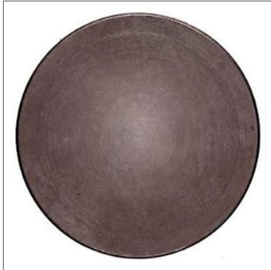
Figura 7. Disco Ti-6Al-4V obtido pelo processo de usinagem após tratamento de superfície ácido-alcalino.
