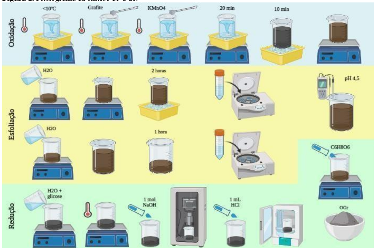
Figura 1. Fluxograma da síntese de OGr.
