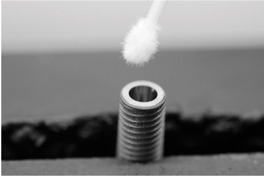
Figura 13- Coleta de amostras do interior do implante após termociclagem e carga cíclica.
