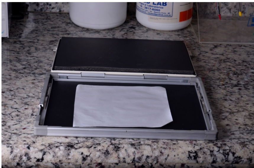
Figura 26- Membrana posicionada para exposição em cassete de autorradiografia.
