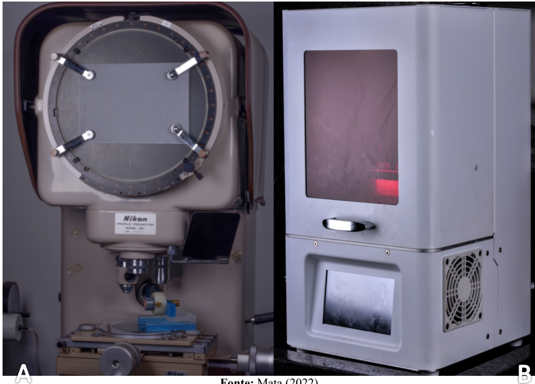
Figura 7- (A) Projetor de perfil e (B) Impressora 3D Phrozen.
