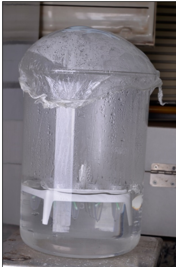
Figura 15- Micro tubos fervidos a 95°C por 5 minutos para a desnaturação das fitas de DNA.
