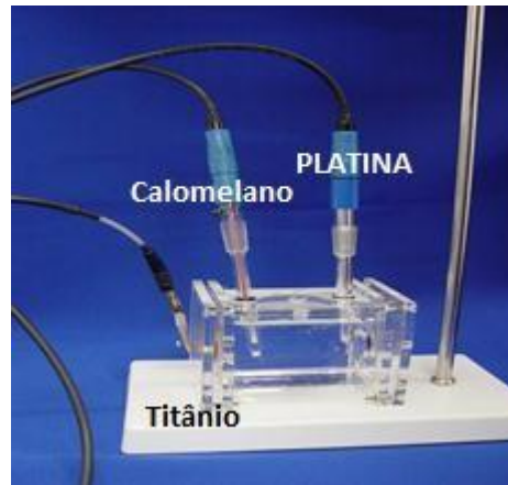
Figura1: Potenciostato e conformação dos eletrodos: Titânio, calomelano e platina em sequência.
