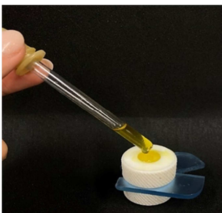
Figura 3 - Cera liquefeita sendo vertida com conta gotas no interior da matriz.
