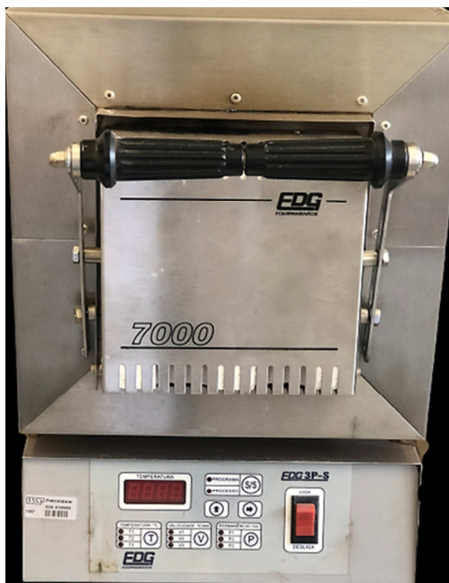
Figura 8 - Forno usado para expansão do revestimento e eliminação da cera.
