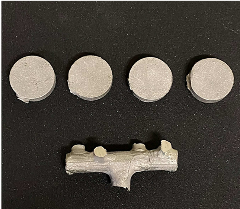
Figura 11 - Espécimes após fundição e separação dos canais de alimentação.
