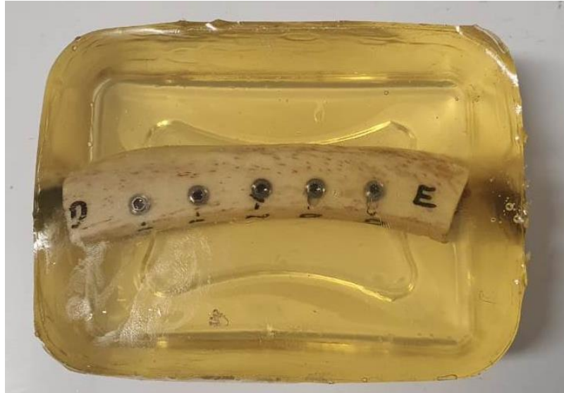
Figura 4 - Imagem mostrando a costela bovina com os implantes instalados incluídos na gelatina balística para simular os tecidos moles
