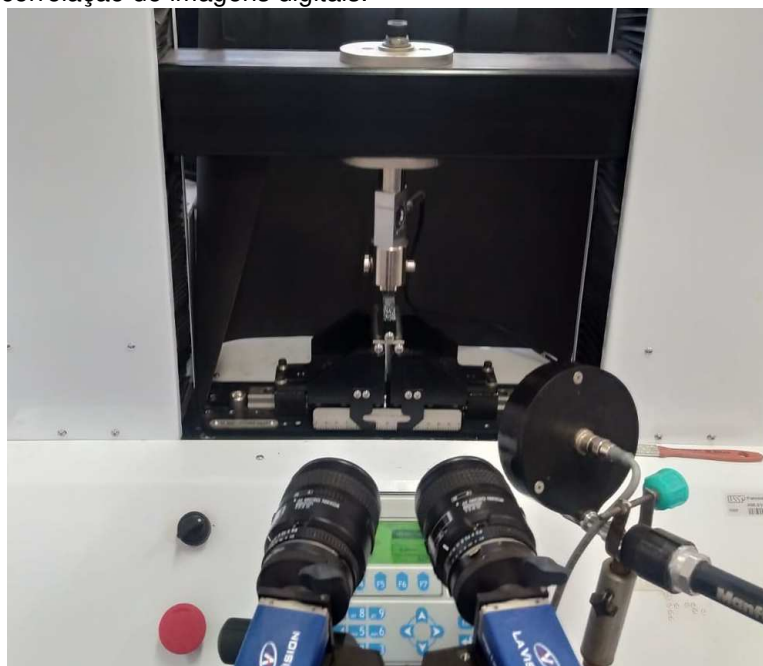
Figura 16. Máquina universal de ensaios e posicionamento do corpo de prova em forma de barra na máquina universal de ensaios para teste de resistência à flexão de três pontos com a carga sendo aplicada em conjunto com a metodologia da correlação de imagens digitais.
