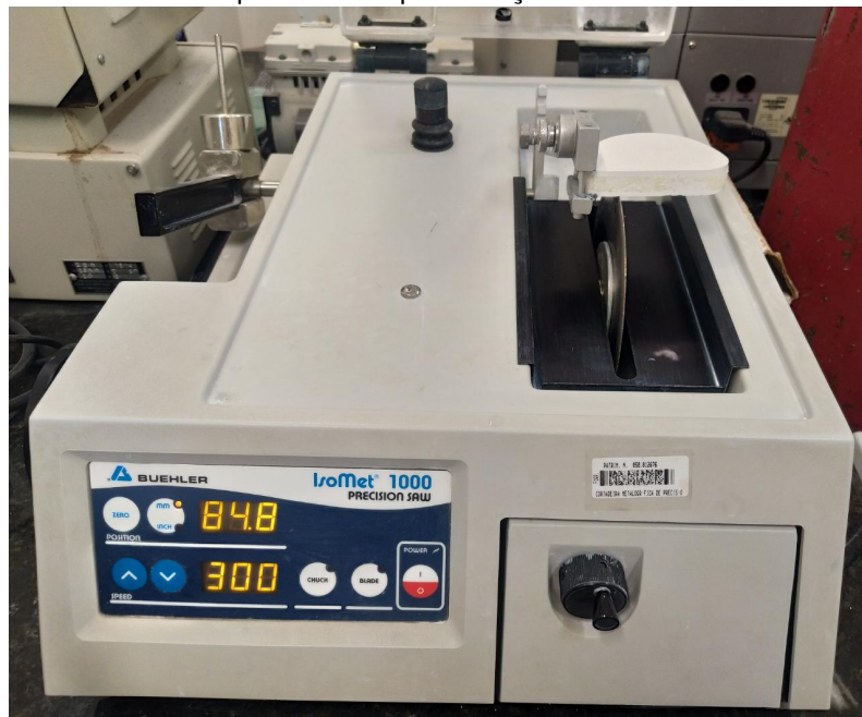
Figura 2. Cortadeira de precisão Isomet 1000 Precision Saw e bloco de zircônia posicionado para secção.
