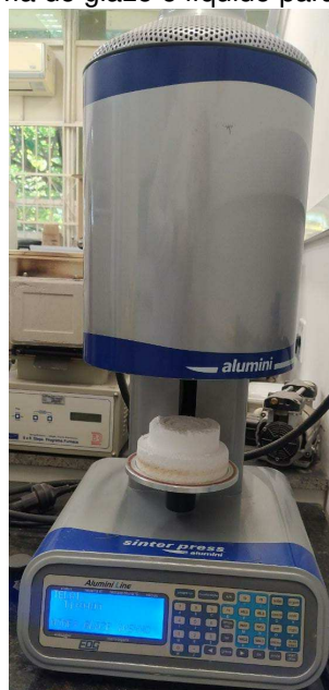
Figura 7. Forno para queima do glaze e líquido para caracterização extrínseca.
