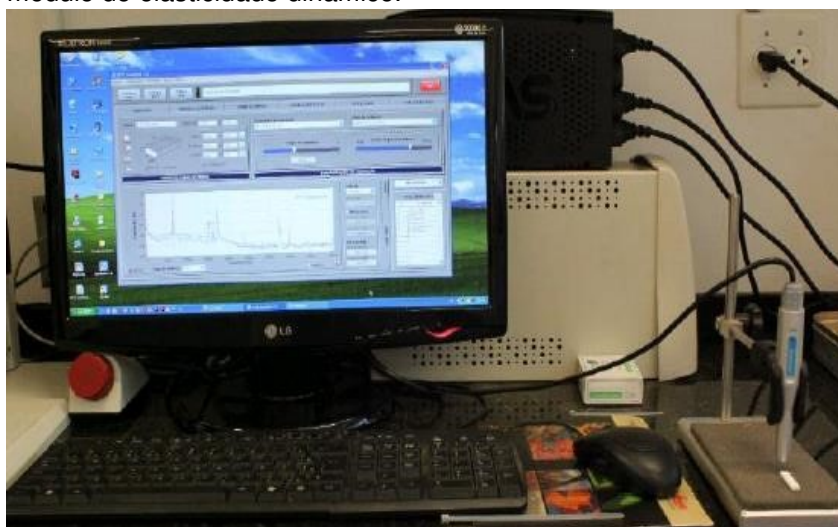
Figura 10. Aparelho e software Sonelastic para mensuração do módulo de elasticidade dinâmico.
