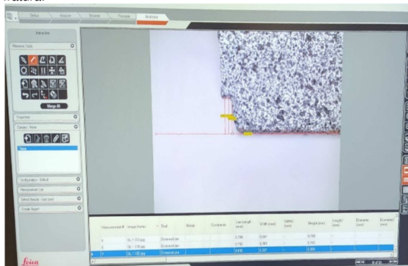
Figura 15. Mensuração em microscópio óptico das faces internas da fratura.
