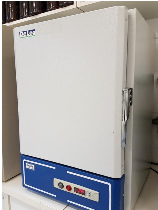
Figura 13: Estufa para controle da temperatura a 37°C.
