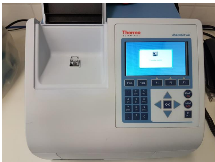
Figura 11: Máquina de espectrofotometro MultiScakn GO(Thermo Scientific, Tokyo, Japão).
