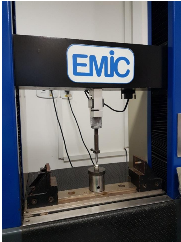
Figura 5: Máquina universal de Ensaio EMIC 2000 (EMIC DL.2000, EMIC, São José dos Pinhais, PR, Brasil) em que foi realizado teste push out .
