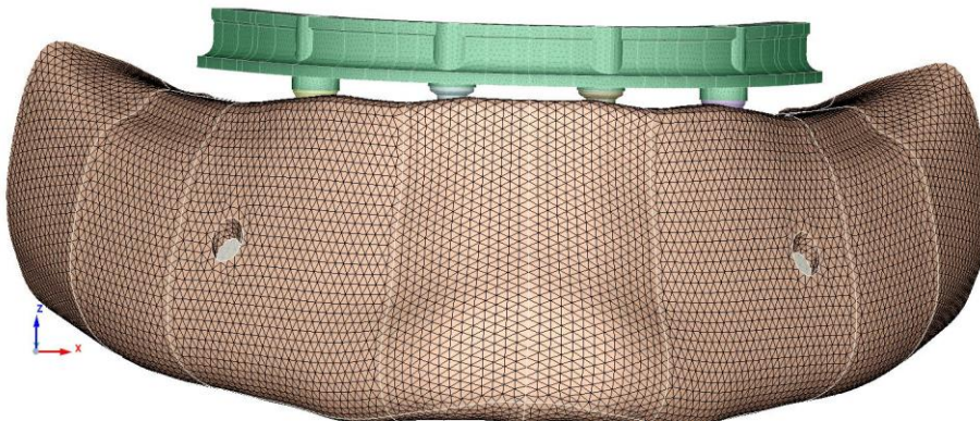
Figura 13. Malha externa e interna de um corte feito na mandíbula, expondo os implantes retos, pilares, parafuso e a barra do 4R.
