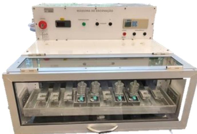
**Figura 24** – Posicionamento das escovas dentais sobre os espécimes com carga de 200g
