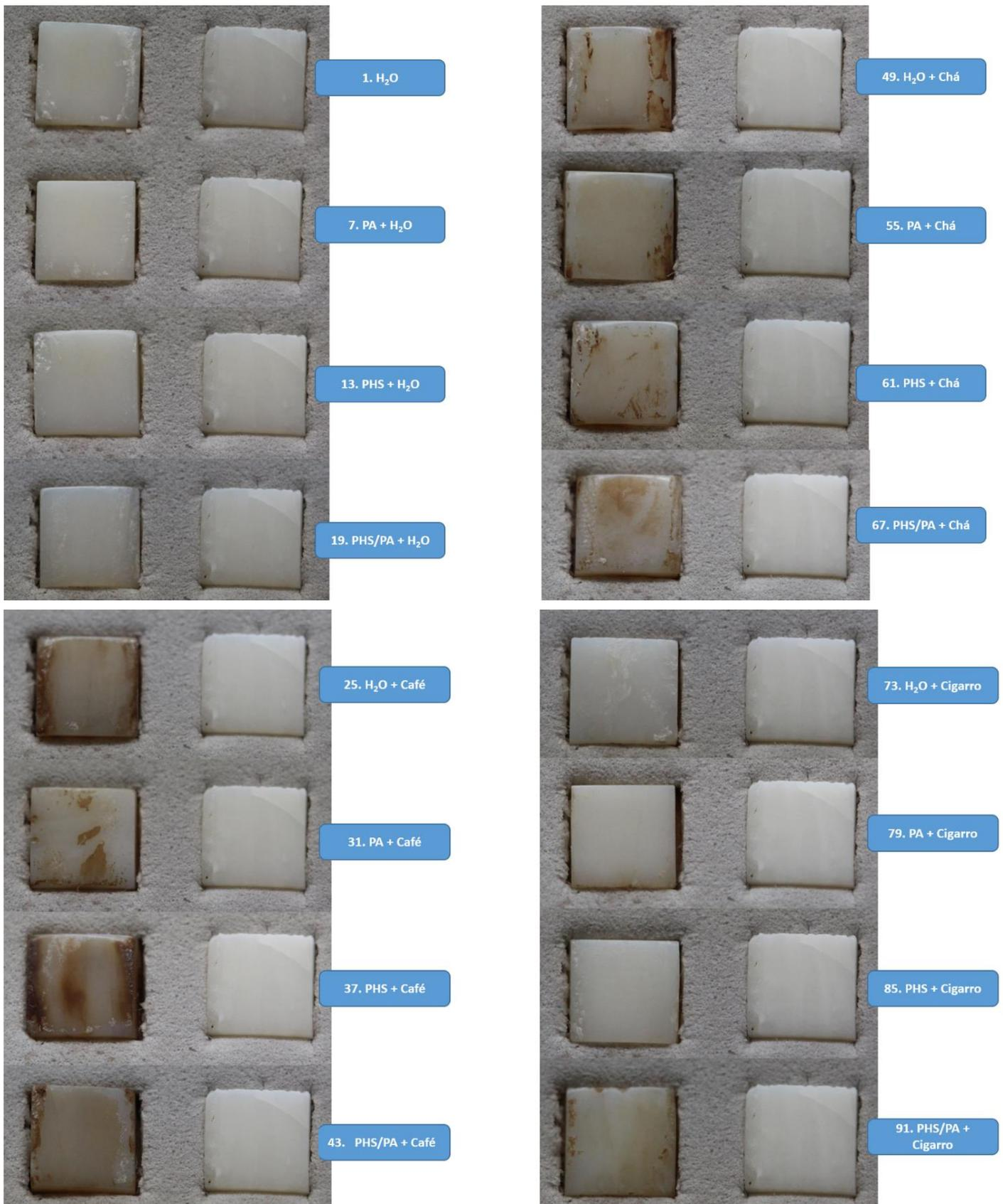
**Figura 26** – Amostras após as diferentes condições de manchamento a que foram submetidas, juntamente com a amostra utilizada como referência de cor.
