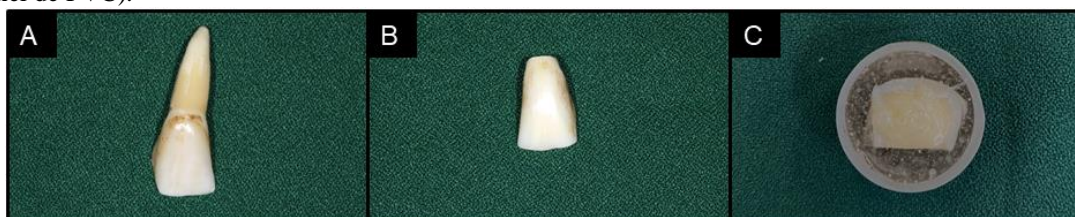
Figura 2 – Preparo e inclusão dos dentes (A: dente limpo; B: coroa seccionada da raiz; C: coroa reduzida e incluída em anel de PVC).
