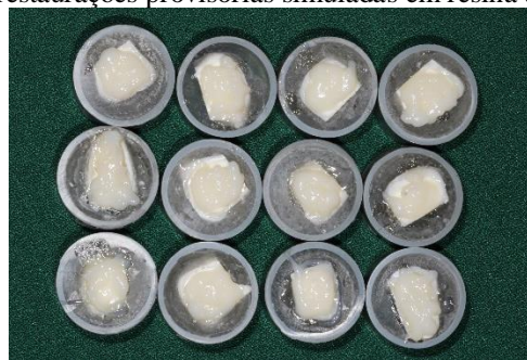
Figura 4: Corpos de prova com restaurações provisórias simuladas em resina bisacrílica.
