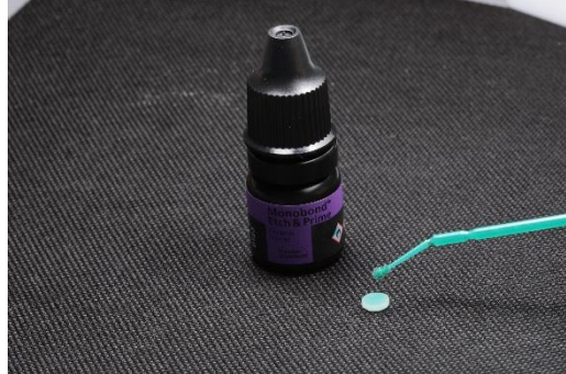
Figura 5: Aplicação do primer cerâmico sobre a superfície do disco cerâmico.
