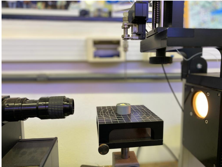
Figura 8: Posicionamento da amostra no goniômetro.
