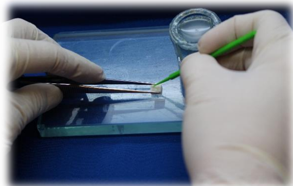
Figura 27 – Aplicação da solução de Biosilicato.
