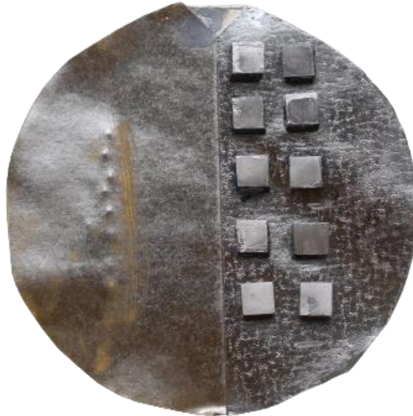
Figura 33 – Amostras metalizadas prontas para leitura em MEV.
