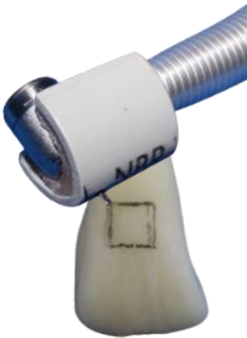
Figura 10 – Dente bovino e dispositivo para padronização da profundidade da cavidade.
