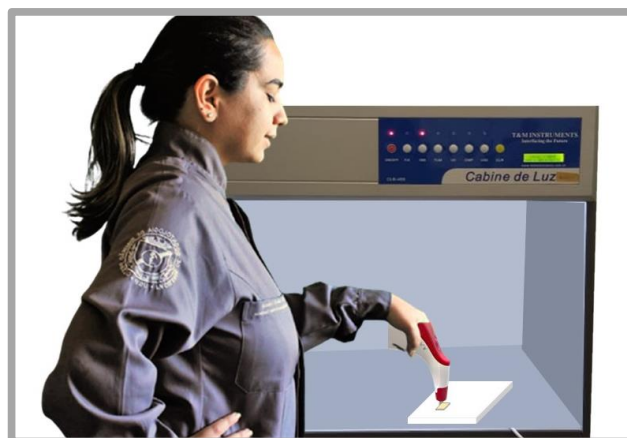
Figura 6 - Procedimento de leitura de cor das amostras, sobre fundo branco padrão em câmara de luz padronizada.
