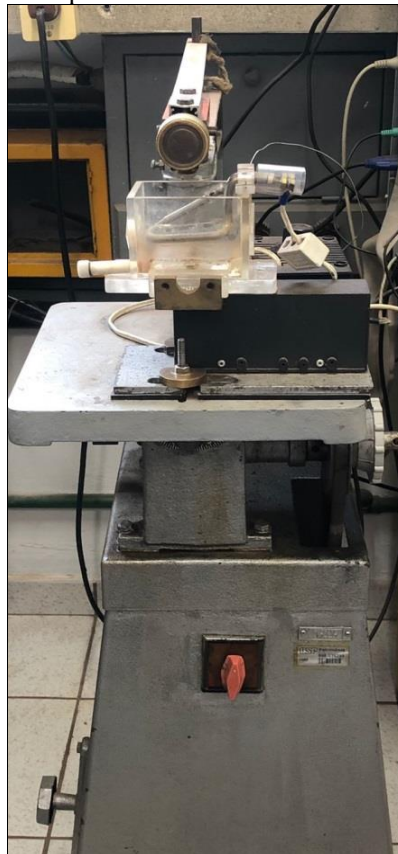
Figura 12. Máquina de ensaios de simulação a fadiga desenvolvida por Rodrigues et al., 2009. Laboratório de Estudos Biomecânicos em Prótese sobre Implantes.
