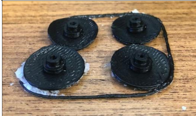
Figura 5. Cápsulas de Poliacetal mostrando o tapete e remanescente de materiais fixadores para tentar amenizar o problema da não aderência do material a superfície da plataforma.
