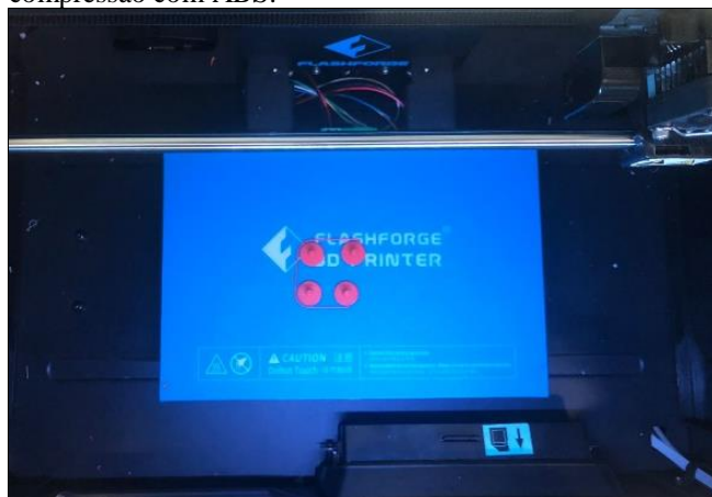
Figura 7. Imagem com vista superior da parte interna da Impressora Flash Forge Creator Pro e sua plataforma ao finalizar a impressão de corpos de prova para o ensaio de compressão com ABS.
