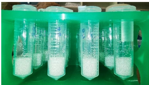
Figura 5: Pérolas de vidro (425-600µm de diâmetro).
