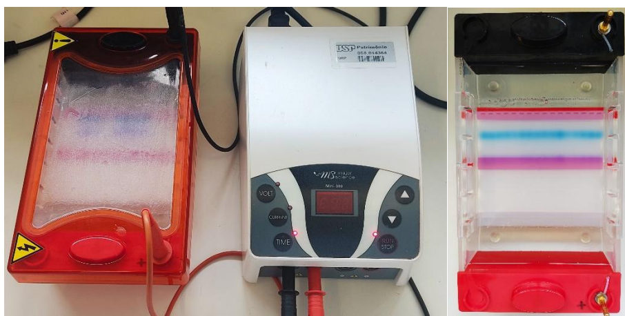
Figura 13: Aparelho de eletroforese. Figura 14: Cuba com gel de agarose em posição.
