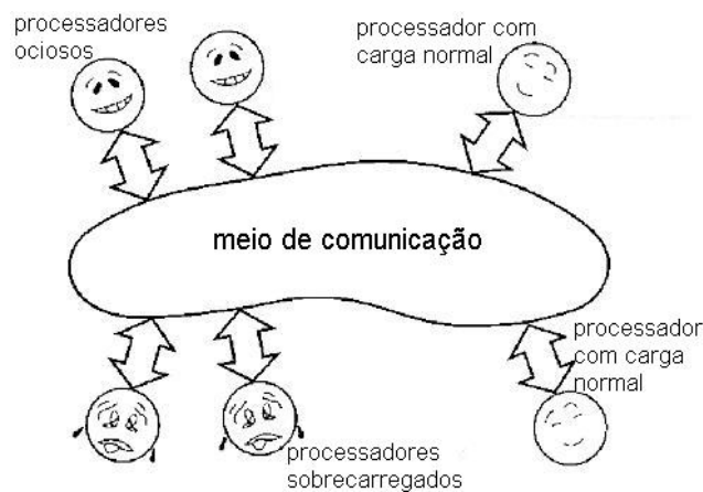
Figura 2.3. Um sistema distribuído sem balanceamento de carga (Shivaratri et al., 1992)
