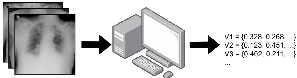
Figura 2 – Processo de extração de características e geração de um conjunto de vetores de características a partir de um conjunto de imagens
