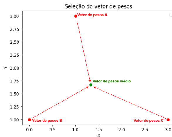
Figura 31 – Exemplo do cálculo do vetor de pesos médio que reflete os pesos médios das dimensões de um conjunto de vetores de pesos
