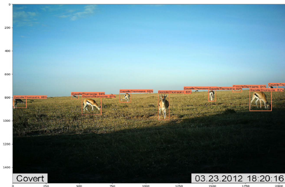
Figura 22 – Uso do algoritmo Faster R-CNN para detectar 10 gazelas-de-thomson do conjunto de dados GSSS e demonstrando as dificuldades das distâncias dos animais durante a detecção.
