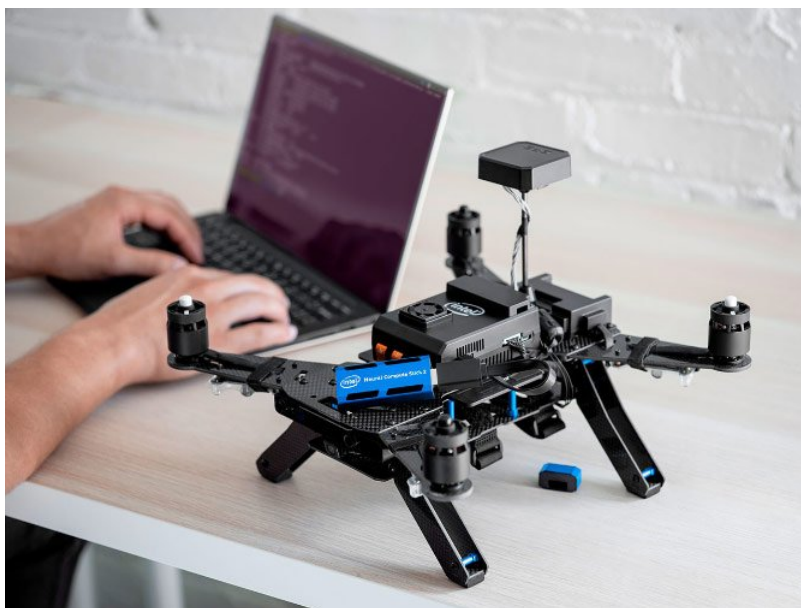
Figura 17 – Imagem ilustrativa de um Intel NCS2 sendo implementado em um veículo aéreo não-tripulado
