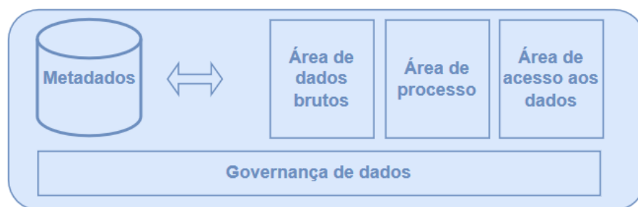
Figura 3 – Componentes de um data lake .
