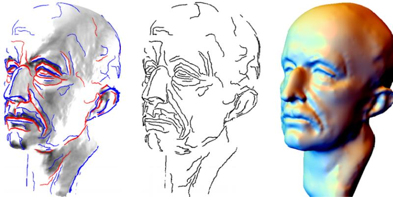
Figura 8 – Busto de Max Planck com as curvas ridge desenhadas sobre a sua superfície, as curvas ridge extraídas do busto, e uma superfície reconstruída a partir destas curvas. Ohtake, Belyaev e Seidel (2004)
